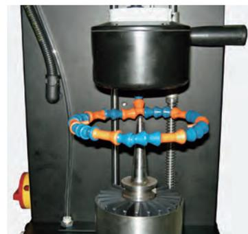
ISG1000 に装着するエア冷却キット。冷却リングを移動してスタートボタンを押すだけの簡単操作。ホルダ形状を問わず、簡単・安全・短時間に冷却が行える。
